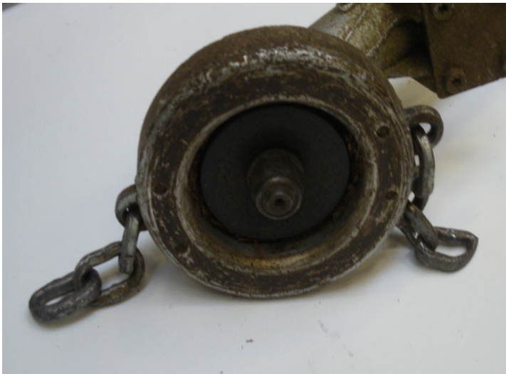
Φωτογραφία 1: Παράδειγμα κοπτικού εξαρτήματος αρθρωτού τύπου με αλυσίδα προσαρτημένο σε θαμνοκοπτική μηχανή
