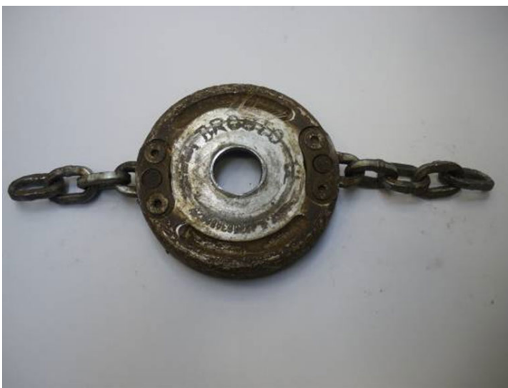
Φωτογραφία 2: Παράδειγμα κοπτικού εξαρτήματος αρθρωτού τύπου με αλυσίδα
